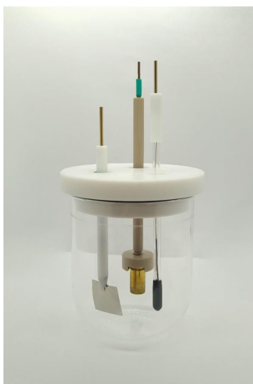
Obr. 5: Kompletní elektrochemická cela (variabilní spodek cely z PTFE materiálu (vlevo) nebo ze skla (vpravo)) s osazením tříelektroodového systému. Vpravo osazení víka elektrochemické cely 3 elektrodami (zleva doprava: pomocná CE – velkoplochá Pt, pracovní W – držák s nábojnicí a referentní RE – chloridostříbrná).
