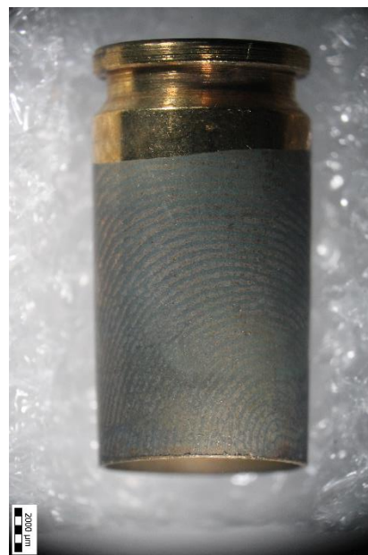
Obr. 7: Záznam (cyklický voltamogram) depozice PTB na nábojnici s naneseným otiskem prstu s vyznačeným prvním cyklem (vlevo) a vizualizovaný otisk prstu na nábojnici (vpravo).
