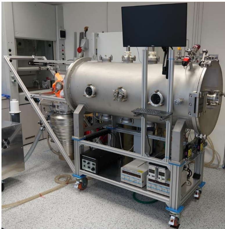
Obr. 7 – Fotografie reálného provedení vakuového systému
