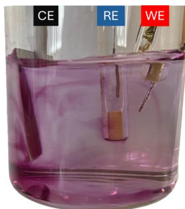
Obr. 5: Elektrodové uspořádání v průběhu čištění cely a elektrod v 0,5 mol/l H_2SO_4 .
