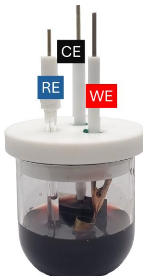
Obr. 12: Elektrochemická cela po ponoření elektrod v připraveném roztoku monomeru NR (v PB s \text{KNO}_3 ) a označení jednotlivých elektrod pro připojení k potenciostatu.
